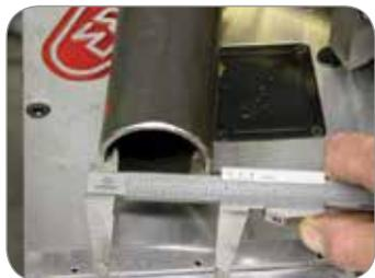
Dimensiones de tubería se basan en I.D. del material (2" cédula 40 de tubería mide 2.375" O.D.)
