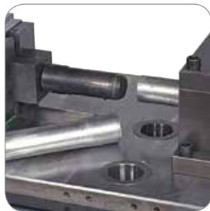
Reduce y expande tubo y tubería
