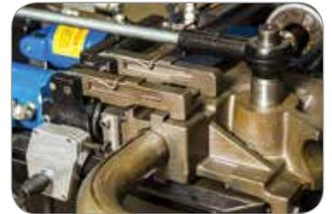
Sistema de abrazadera con dedos hidráulicos (FST) este sistema minimiza la distancia entre las abrazaderas.
