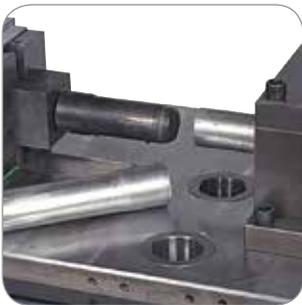
Reduce y expande tubo y tubería
