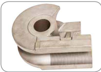
**Matriz/Contra-Matriz:** La herramienta principal que determina el radio de doblé. Fabricado de acero o acero de aleación y tratamiento térmico según las necesidades. La cara de la abrazadera es dentada para ayudar a la fuerza de agarre.
