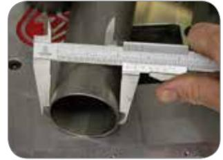
Dimensiones de tubo se basan en O.D. del material (2" tubo mide 2.00" O.D.)
