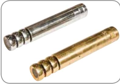
**Mandrill:** Generalmente hechos del mismo material del dado de soporte. Función primaria del mandril es evitar que dentro del diámetro del tubo se colapse. Elegir el mandril correcto es muy importante en la determinación de la calidad del doblez. Tres estilos básicos de mandril son:
