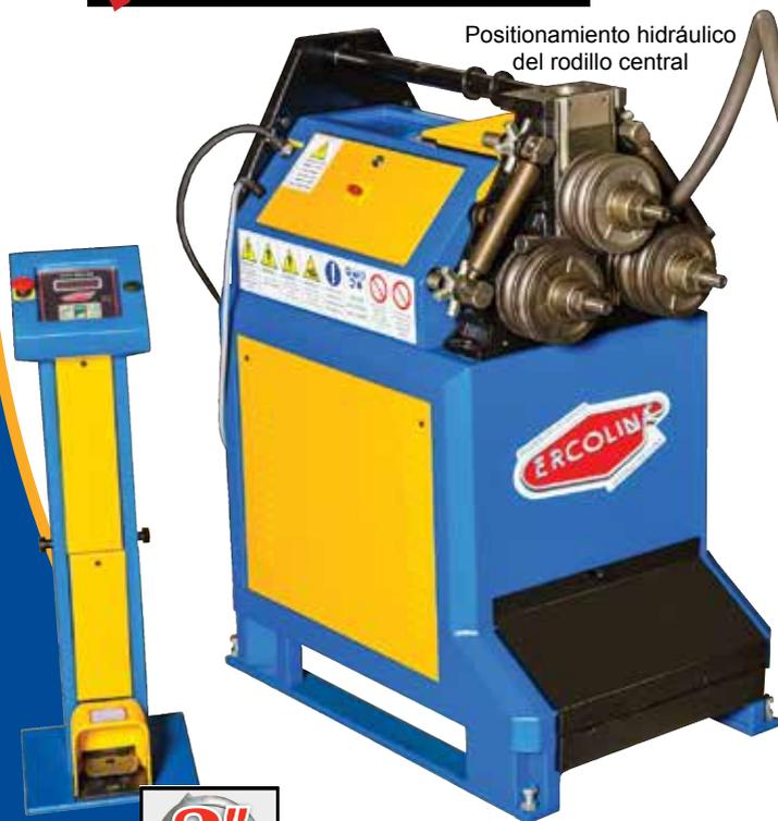
Posicionamiento hidráulico del rodillo central
