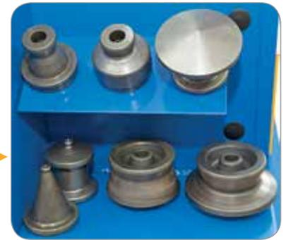
La máquina Ercolina modelo EFB 220 forma al frío una variedad de materiales incluyendo acero inoxidable, acero, cobre y aluminio a los ensanches de 90° en tubos de 20 hasta 220 milímetros de diámetro con espesor de pared máximo de 5 mm de grosor.
