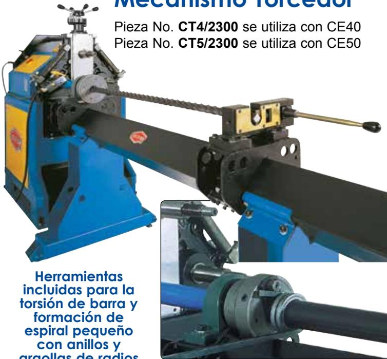
Herramientas incluidas para la torsión de barra y formación de espiral pequeño con anillos y argollas de radios mínimos
