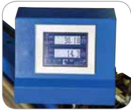
La pantalla táctil está montada en el contrapunto de la mesa mandril y se sincroniza con la pantalla principal de control.
