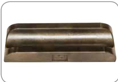
**Dado de Presión:** Mantiene una presión constante en el tubo tangente en donde el doblé se produce, proporcionando fuerza reaccionaria para hacer el doblé. Longitud del dado de presión depende del grado del doblé (DOB) de la pieza siendo doblada y el diseño de la máquina.
